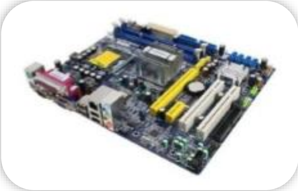
RR-MB-1155G. Tarjeta Madre 1155 Dual Core i3/i5/i7, DDR3, Recertificada
